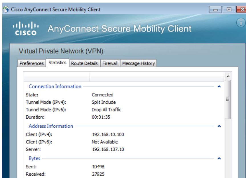
Figura 4.7 Comprobación de conectividad VPN
