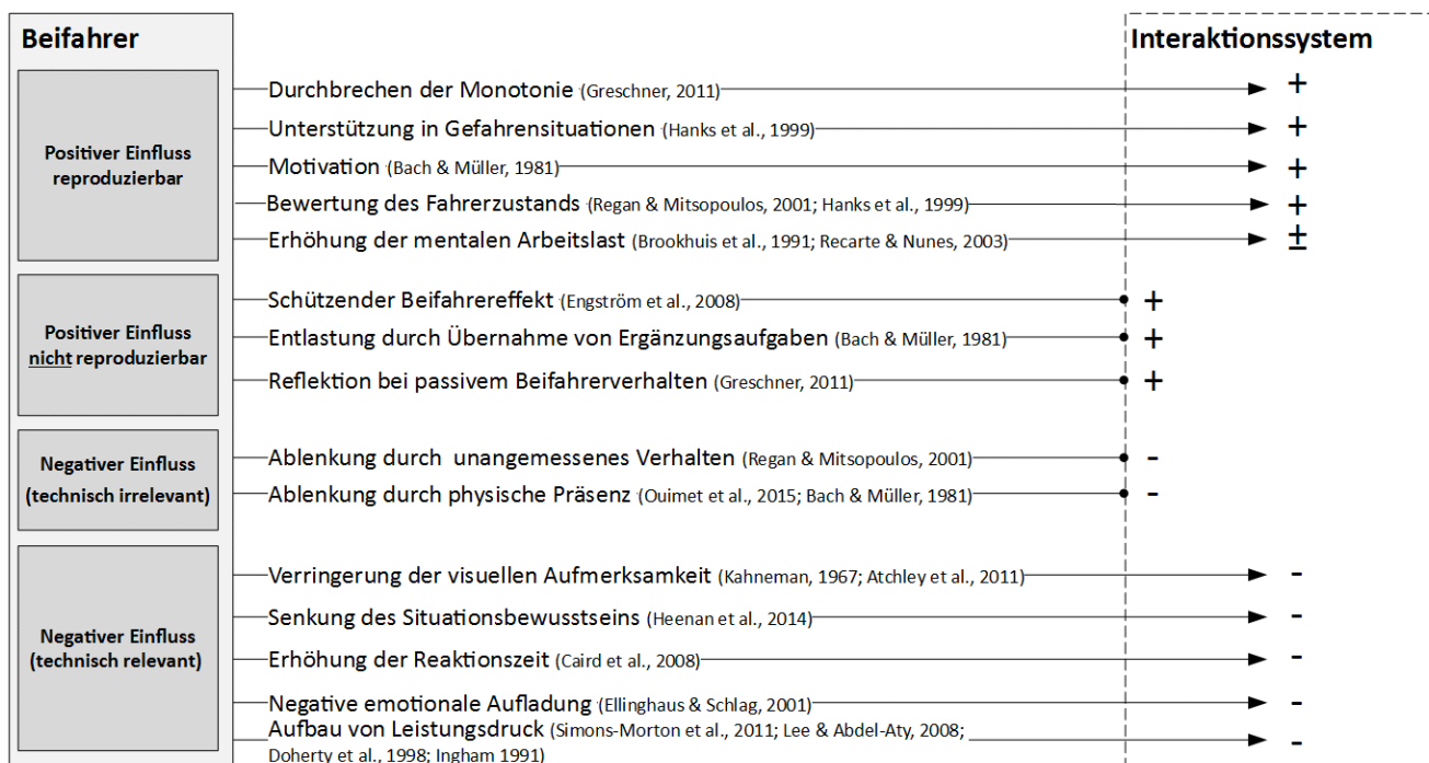
Abbildung 9: Einflüsse des Beifahrers auf den Fahrer und deren Relevanz für den Vergleich zu technischen Interaktionssystemen
