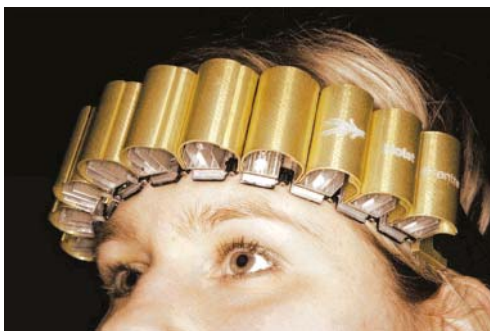
Figura 15: Detalle del Recolector de energía térmica de un sensor autónomo inalámbrico (oxímetro de pulso y monitor 2ch-EEG).
