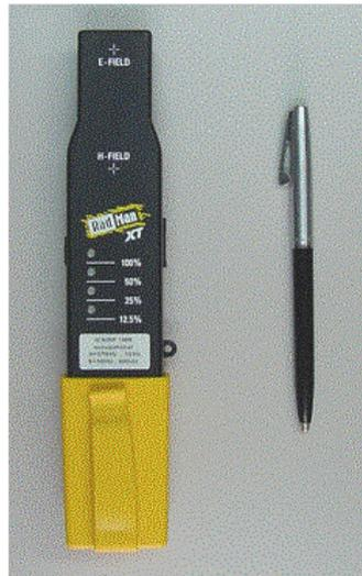
Figura 3.2. Monitor de radiación RadMan XT ESM-30
