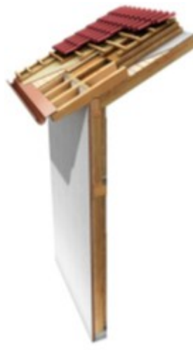
Figura 47. Detalle de empalme fachada – cubierta. Fuente: Daniel Huertas Páez
