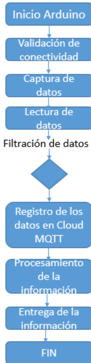
Figura 15. Diagrama de Flujo del Sistema de Monitoreo
