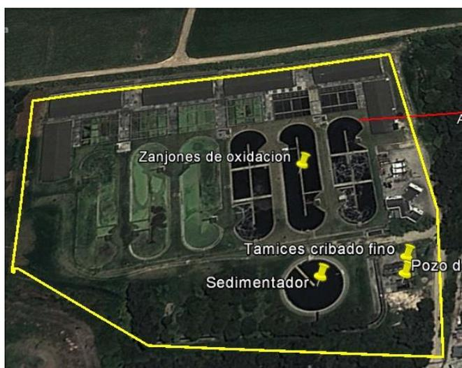
**Figura 4 Esquema general de la Planta de Tratamiento de Aguas Residuales**
