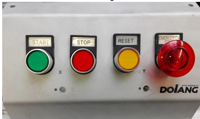
Ilustración 77. Tablero de control con Paro de Emergencia
