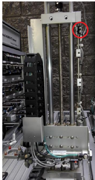
Ilustración 53. Finales de carrera en ejes
