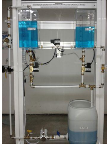
Ilustración 4. Estación didáctica de control de nivel y caudal
