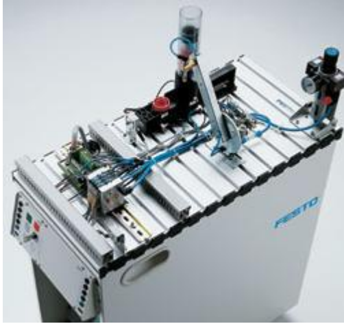
Ilustración 2. Estación de distribución MPS de FESTO
