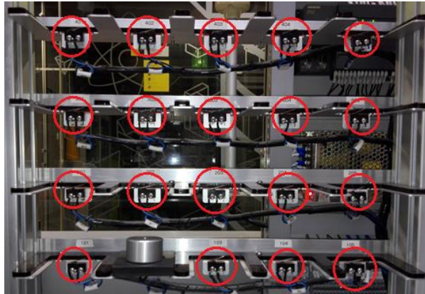
Ilustración 43. Sensores de contacto en el sistema de almacenamiento
