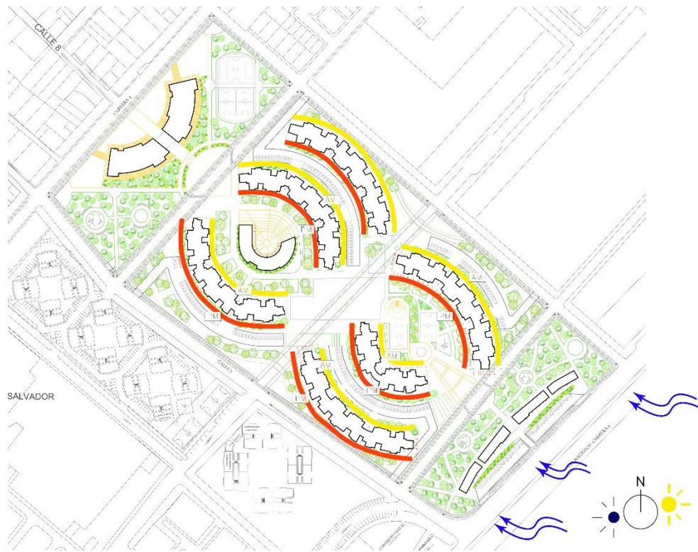
Figure 12 Bloques orientados sentido Norte-Sur para el aprovechamiento de la luz natural en la mañana y la tarde. Y bloques ubicados en sentido de los vientos más dominantes,
