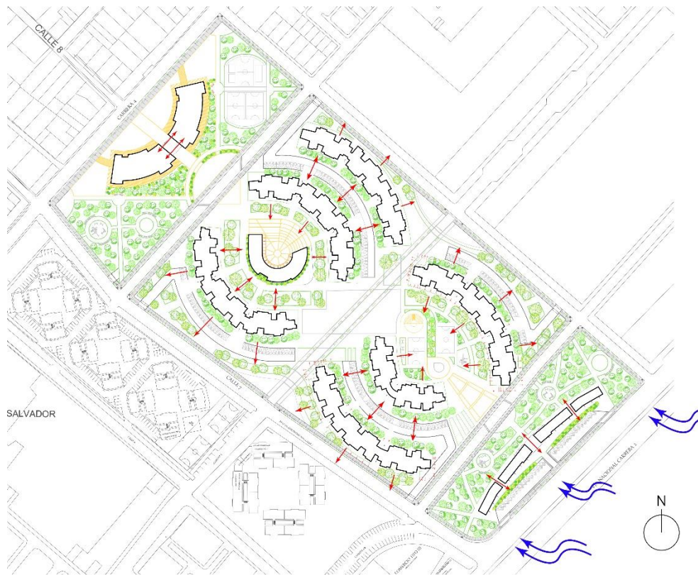
Figure 11 Aislamiento de bloques (bloques aislados para evitar el efecto embudo)
