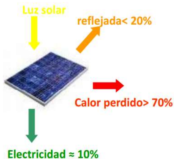
Figura 18. Comportamiento celdas solares
