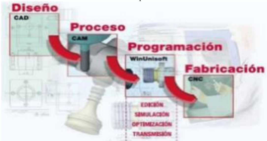
Figura 32. Procedimientos para la manufactura de un producto por medio de una máquina CNC
