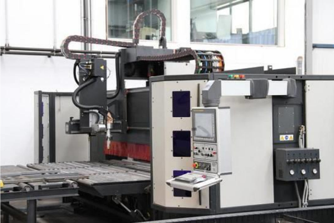
Figura 3. Máquina combinada corte por plasma / oxicorte y mecanizado.
