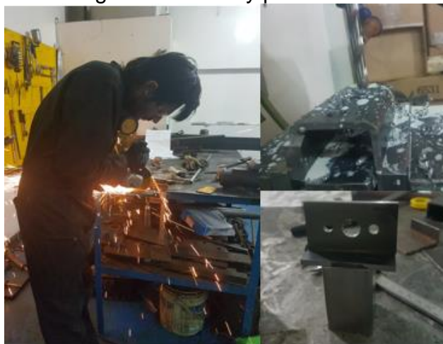
Figura 44. Corte y perforación.
