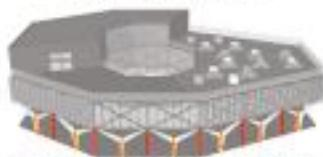
Las columnas en "Y" se disponen a rasera de base del edificio, en flexión y al determinar se le altura de 4 metros, rematada a los 2 metros para dar permeabilidad en la planta libre
