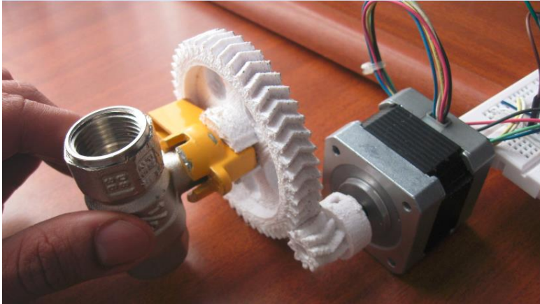
Figura 28. Unión de piñonearía con el servomotor.
