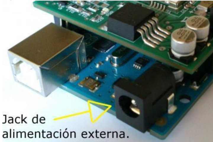
Figura 10. Terminales de conexión alimentación de energía.
