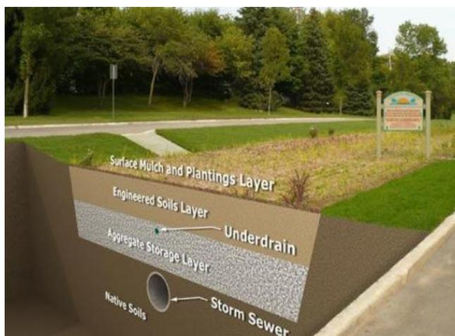
Figura 36. Dren filtrante de capas granulares, Pedro Villate, 2017, recuperada de: lineamientos del componente paisajístico (Empresa de Acueducto y Alcantarillado de Bogotá, 2011, Plan de Manejo ambiental y paisajístico de las Obras).
