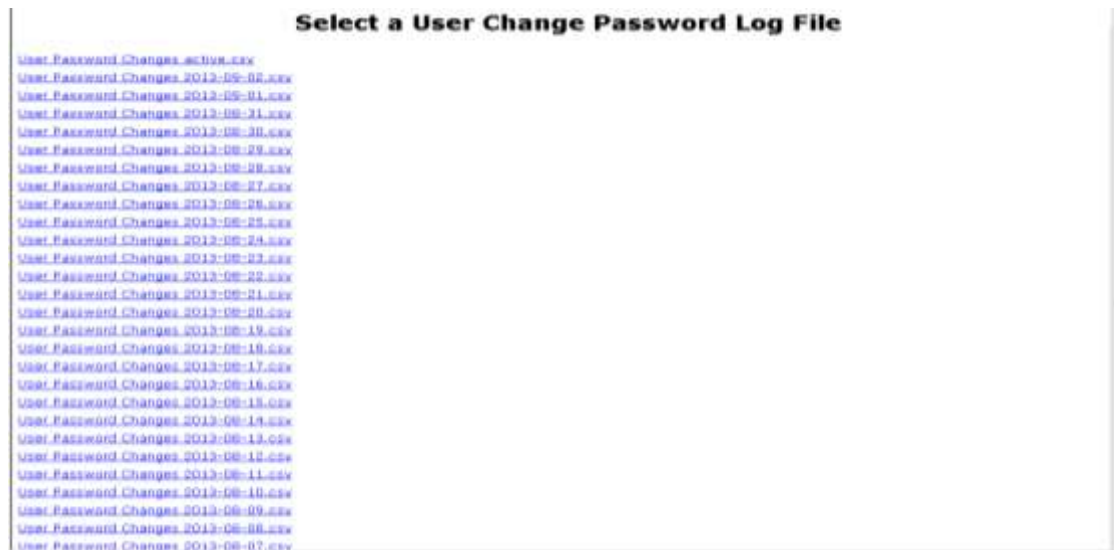
Figura 39. Log Eventos usuarios que han cambiado la contraseña por medio del Administrador del Servidor AAA autenticación TACACS+
