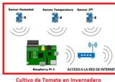
Figura # 7: Composición interna del nodo de sensores. Fuente: Propia.
