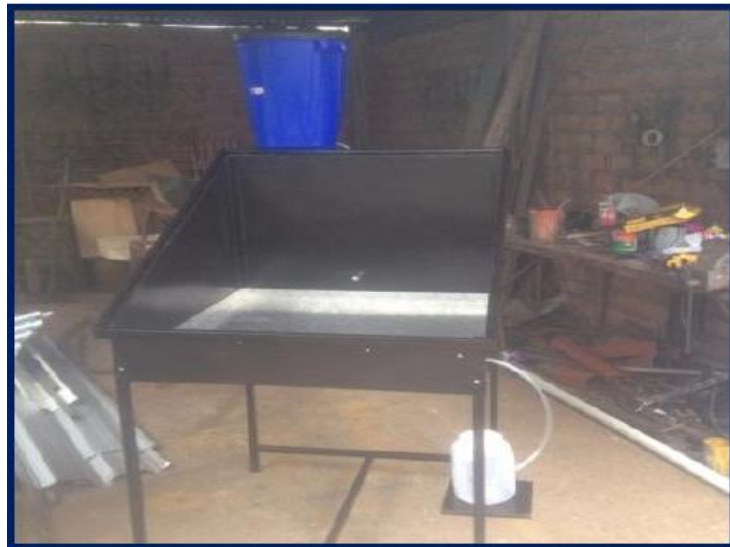
Fuente: ALBAN ULLOA, José Alexander: Destilador solar para potabilizar el agua para una familia de 3 a 4 personas en el sitio bajo alto cantón el guabo provincia del oro. Machala. 2015.
