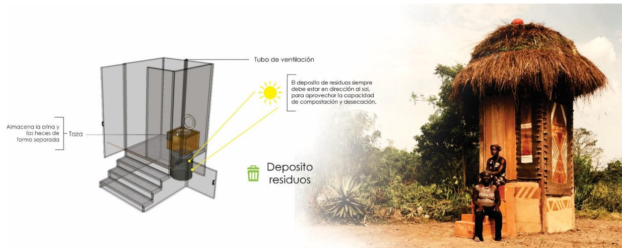
Ilustración 42 Baño Seco. Fuente: Elaboración Propia con base en diseños encontrados en la fundación Organismo
