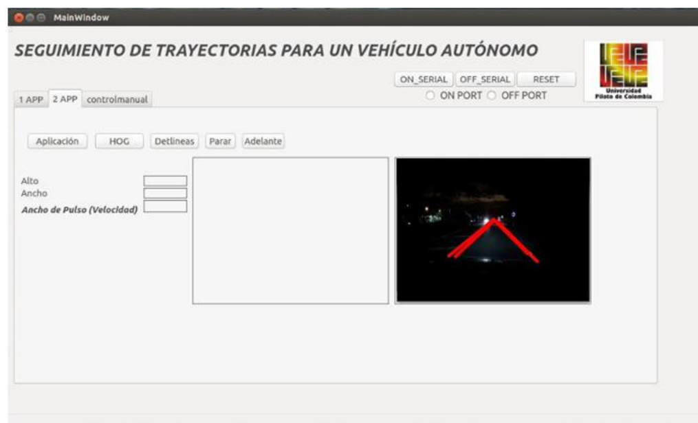
Figura 168. Representación de la aplicación detección de líneas en la vía
