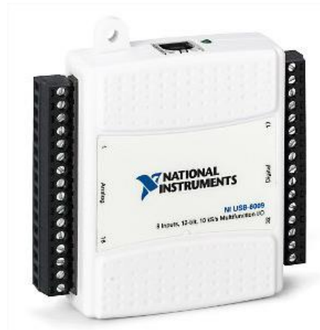
Figura 1. Tarjeta de adquisición de datos NI ref. USB-6009.
