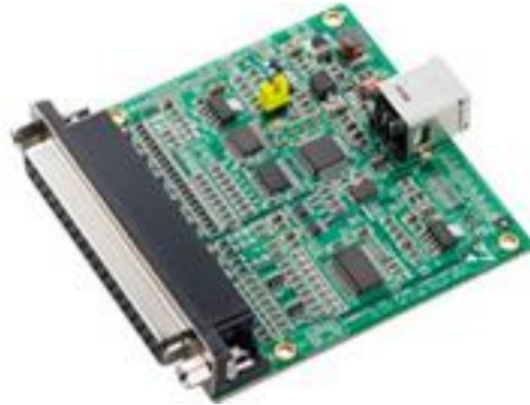
Figura 3. Tarjeta de adquisición de datos Avantech ref. USB-4702.
