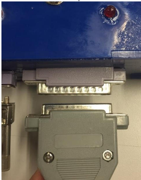
Figura 4. Conexión y acople del conector db-25 a la tarjeta de adquisición.
