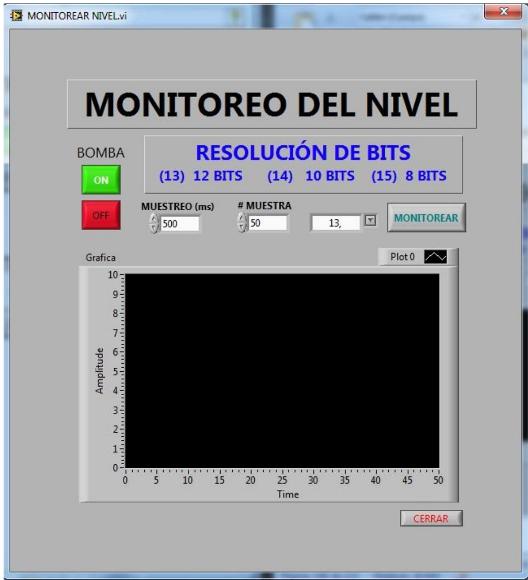
Figura 18. Ventana para Monitorear Nivel.
