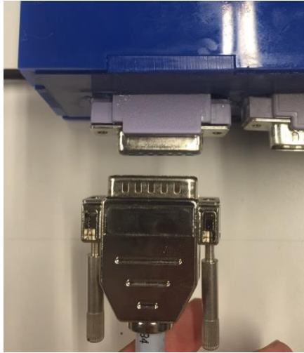
Figura 3. Conexión y acople del conector db-15 a la tarjeta de adquisición.
