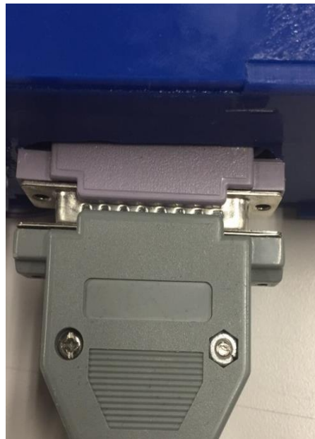
Figura 4. Conexión y acople del conector db-25 a la tarjeta de adquisición.
