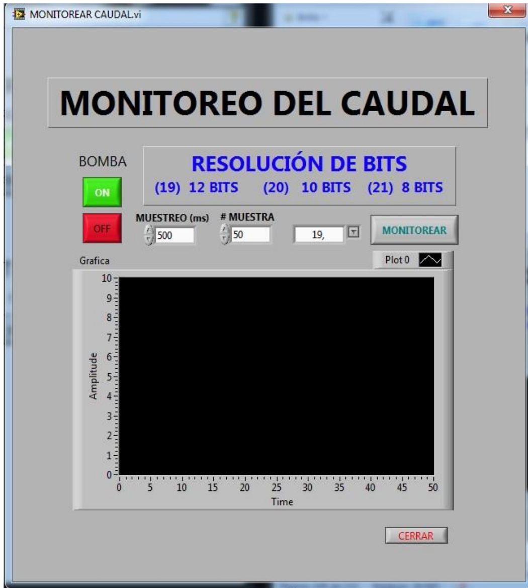
Figura 20. Ventana para Monitorear Caudal.
