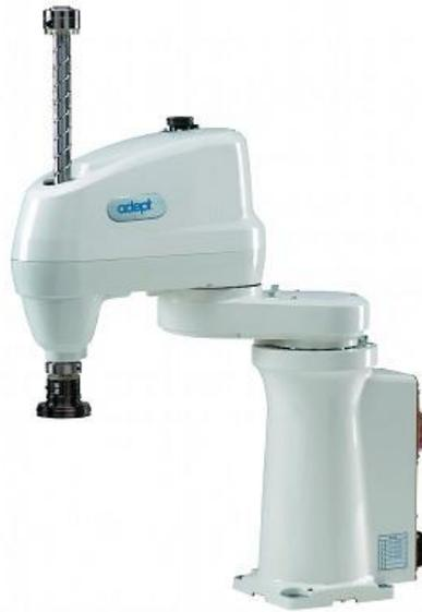
*Ilustración 5. Robot SCARA de 4 ejes, tomada de [9].*
