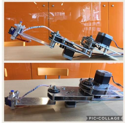
Imagen 45. Ensamblaje de los eslabones con extrusor. Fuente propia.
