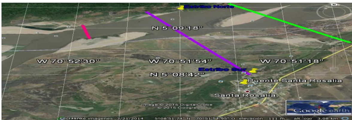
Ilustración 50 Plano de alternativas de trazado en planta puente vehicular Santa Rosalía - Bocas del Pauto
