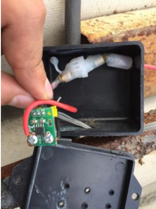
Figura 39. Sensor de corriente instalado con caja de protección.
