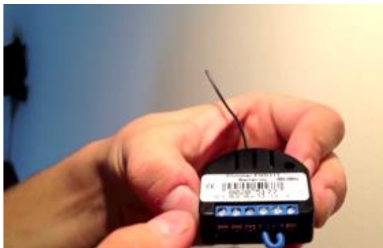
Figura 40. Micro Dimmer fibaro para control de iluminación.
