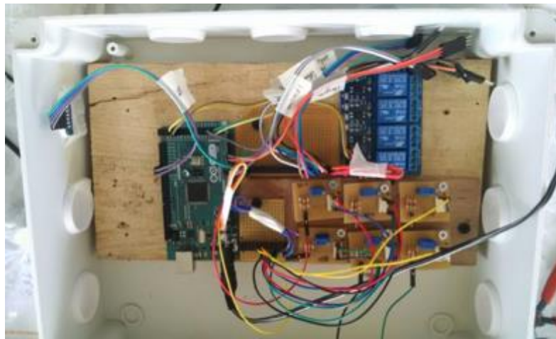
Figura 32. Tarjeta arduino atmega con conexiones
