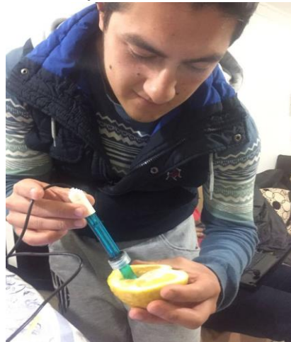
Figura 34. Medición del pH en la naranja con sonda.
