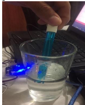
Figura 30. Medición del pH en el agua con sonda.
