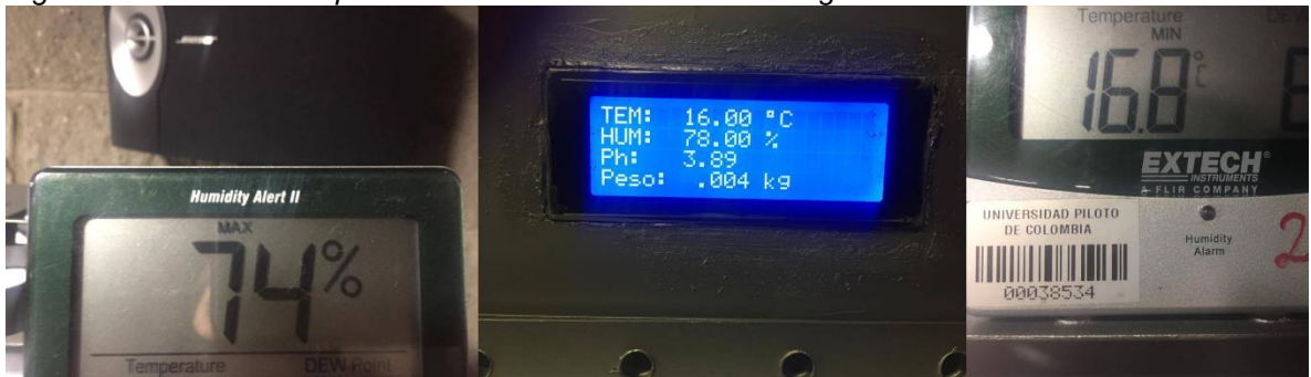
Figura 27. Resultados experimentales del sensor con termo higrómetro.
