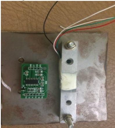
Figura 17. Sensor celda de carga HX711.
