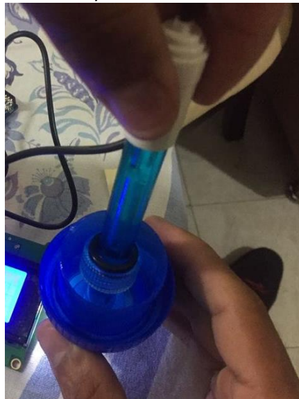
Figura 38. Medición del pH en el blanqueador con sonda.
