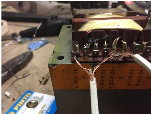
Figura 69. Transformador de la selladora.
