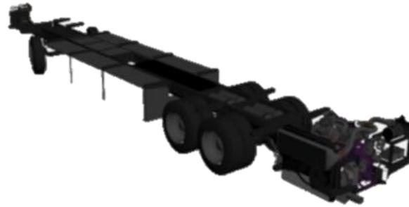
*Imagen 18. Chasis Scania. Tomado de: <http://www.scania.es>*
