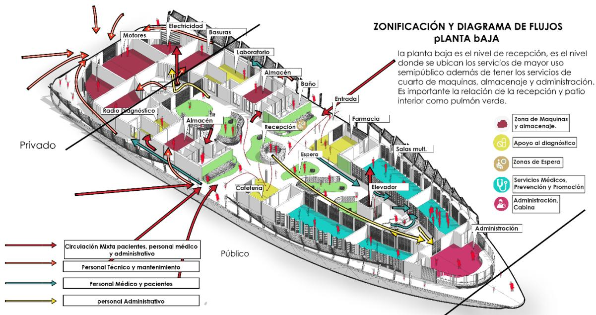
Figura N° 17: Zonificación y diagrama de flujos 1 piso. (Autoría propia, 2017).
