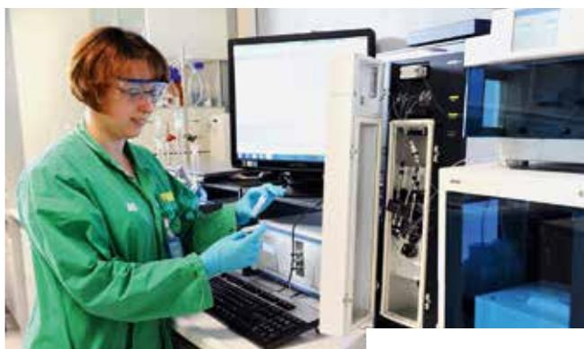
**NANO-ANALYSE:** Madlen Matterna an der Anlage für „Ultra-hochleistungsflüssigkeitschromatographie“, mit der in sehr kurzer Zeit chemische Reaktionsprodukte in geringsten Konzentrationen analysiert werden können. Foto: Frank Bierstedt
