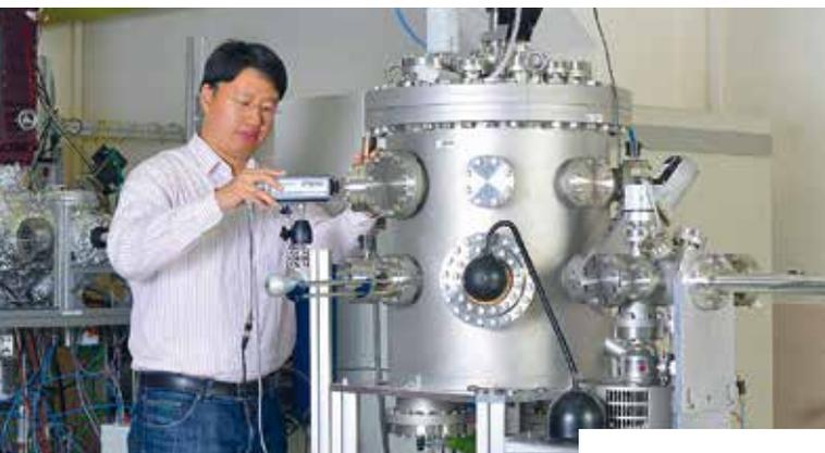
**NANO-FABRIKATION:** Xin Ou prüft die Temperatur, die je nach Material zwischen 200 und 600 Grad Celsius liegen kann. Bei gleichzeitigem Beschuss mit niederenergetischen Teilchen entstehen die gewünschten Nanostrukturen. Foto: Matthias Rietschel
