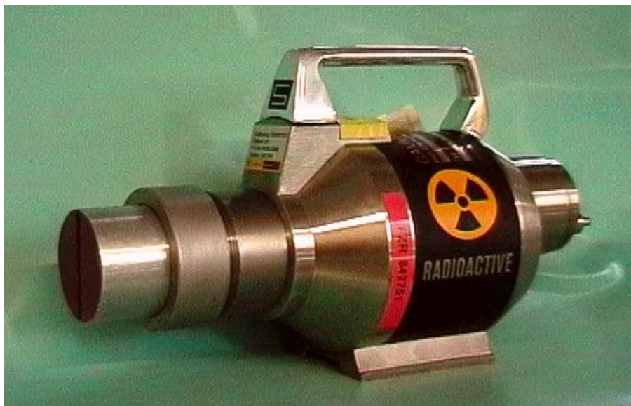
Bild 3.9: Der für den Tomographen beschaffte Quellencontainer (Typ TIFF) der Firma Sauerwein (mit Kollimator)
