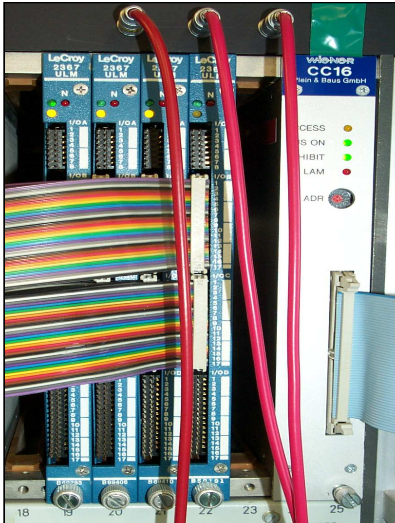
Bild 2.5-1 – Die universellen Logikmodule LeCroy 2366 und 2367, rechts der CAMAC-Controller CC16
