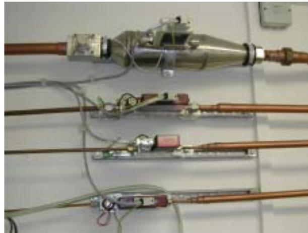
Bild 2.17 Viersträngige Durchsatzmess- und -regelstrecke für Luft
