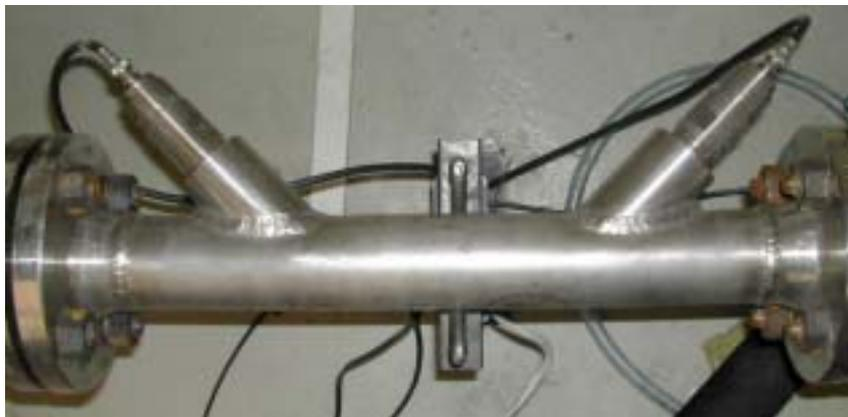
Bild 2.19 Ansicht des Ultraschall-Laufzeit-Volumenstromgebers
