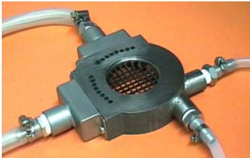
Bild 3.4 Sensor für 7 MPa und 286°C zu Messungen während der transienten Kondensationsversuche
