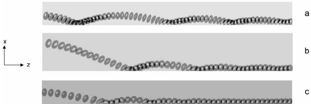
Bild 2.16 Beispiele von gleitenden und abprallenden Blasen entlang einer vertikalen Wand (im Bild um 90° gedreht), aneinander gereihte Bilder einer Hochgeschwindigkeitskamera:
