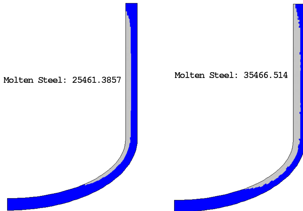
Bild 5-34: Homogener Schmelzpool, erodierter RDB-Stahl (kg), links ohne Korrosion, rechts mit Korrosion
