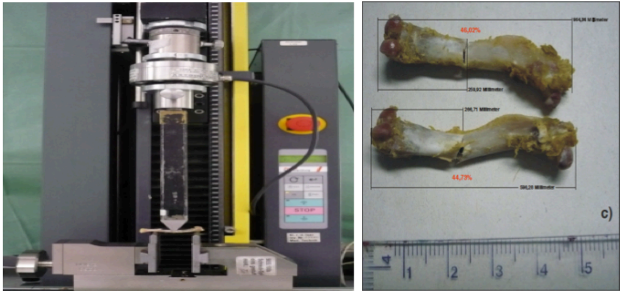
Abb. 7 Darstellung der Prüfmaschine mit der Möglichkeit der individuellen Anpassung des Auflageabstands (links) und Femora nach der biomechanischen Testung: Die Fraktur erfolgte im erwarteten Abschnitt.
