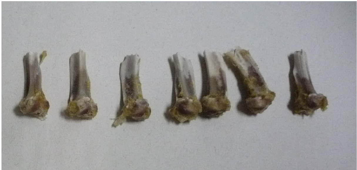
Abb. 9 Darstellung frakturierter Knochen nach Durchführung des 3-Punkt Biegetests
