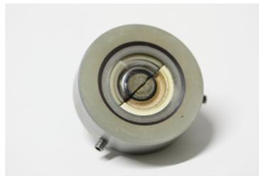
**Abbildung 4.8** Fotografie eines in den Targethalter eingebauten Targets bestehend aus einer Hälfte Zinkoxid (grau) und einer Hälfte Zinnoxid (weiß-bräunlich) nach einer Abscheidung. An Kante zwischen den beiden Hälften ist die erhöhte Abnutzung deutlich zu erkennen.
