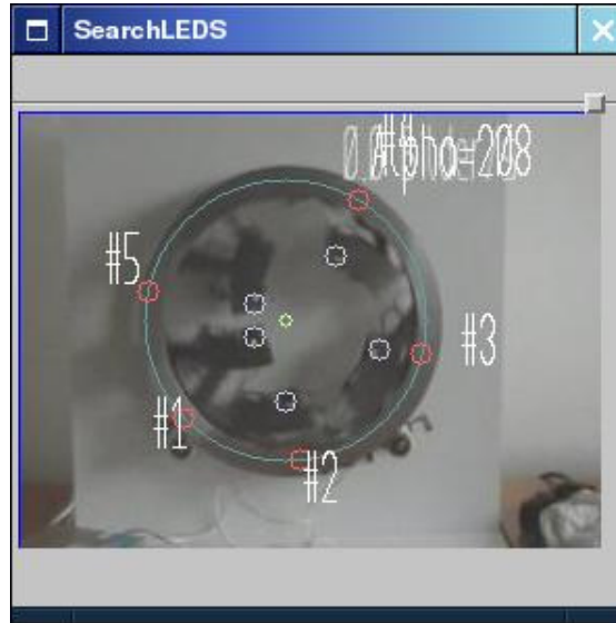
Abbildung 3.7: LED-Suche bei micro.eva. Blau eingekreist sind die LED-Positionen p_i . Aus ihnen wurden die \Gamma_i berechnet, die auf dem Radaußenkreis eingezeichnet wurden. Man kann hier sehen, daß zwischen \Gamma_{i_{Arm_4}} und \Gamma_{i_{Arm_5}} ein Abstand von mehr als 72^\circ besteht.
