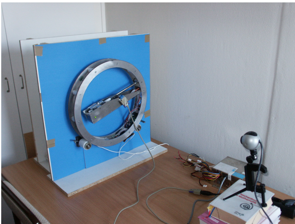
Abbildung 1.1: micro.adam (Version 1) im Blickfeld einer Webcam. Das an seinem Arm befestigte Kabel liefert Servosteuerungsinformationen vom bildauswertenden Computer.
