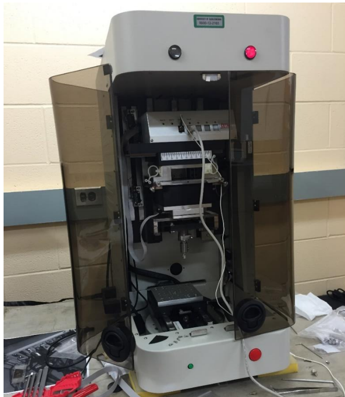
Figure 3-7. CETR UMT tribometer
