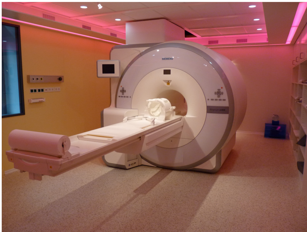
Abbildung 3: PET/MRT-Scanner am Universitätsklinikum Leipzig AöR (Siemens Biograph mMR). Der PET-Detektorring ist in die Bohrung des 3T-MRT integriert.
