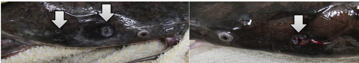
Abbildung 23: Strommarken am Elektrodenansatz (Variante 2: trocken, 250 V)
