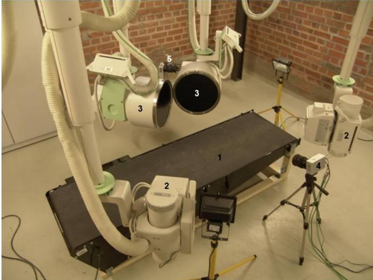
Abb. 9: Versuchsaufbau für die biplanare fluoroskopische Kinematografie.
