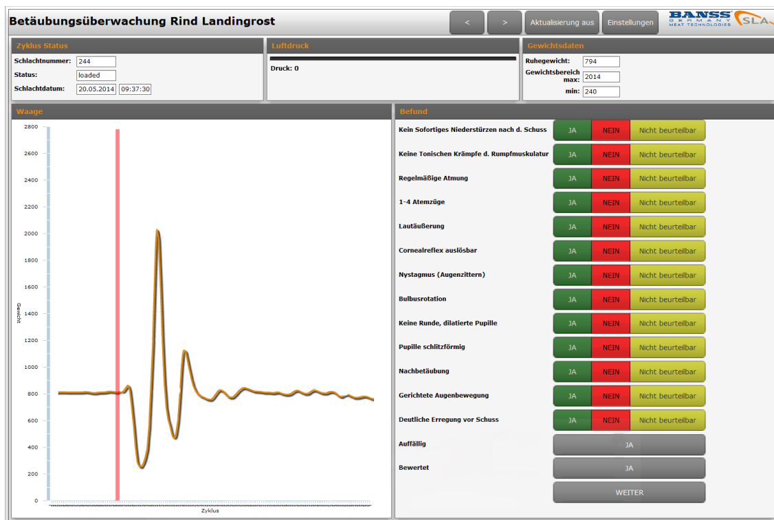
Abb. 3.9 Terminal 1 am Auswurfrost mit Wiegekurve (links) und Eingabe der Befunde (rechts; Text siehe Tab. 3.1)
