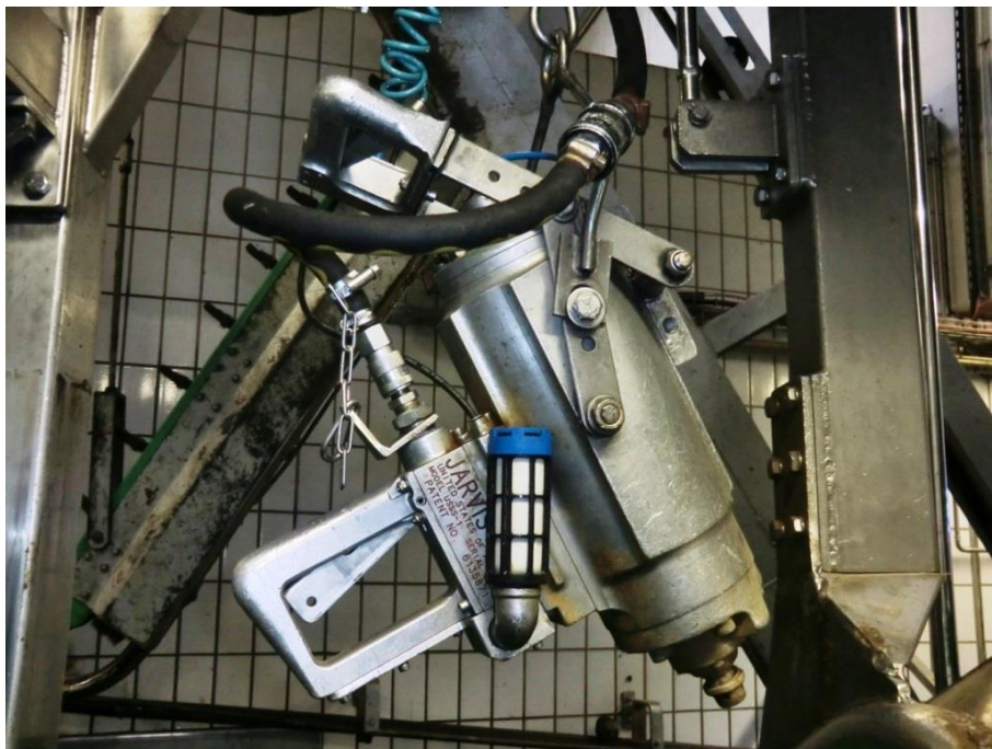
Abb. 3.7 Pneumatisches Bolzenschussgerät USSS-1 (Firma Jarvis, Middletown, CT, USA)
