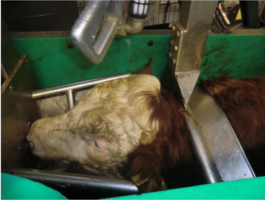
Abb. 3.4 Kopffixierung mittels Nackenjoch und horizontaler Kopfauflage
