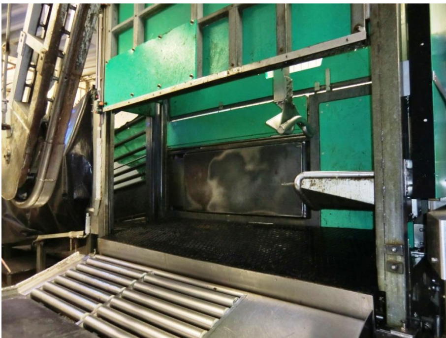
Abb. 3.5 Betäubungsfalle bei geöffneter Seitenwand mit Kippboden, Auswurfrost und Kopffixierungselementen
