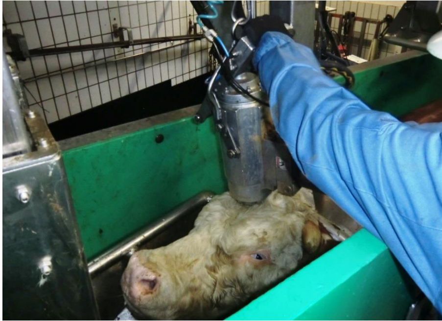
Abb. 3.8 Korrekter Ansatzpunkt des Bolzenschussgerätes am Rinderschädel
