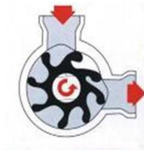
Abb. 3: schematische Darstellung der Funktionsweise einer Zentrifugalpumpe
