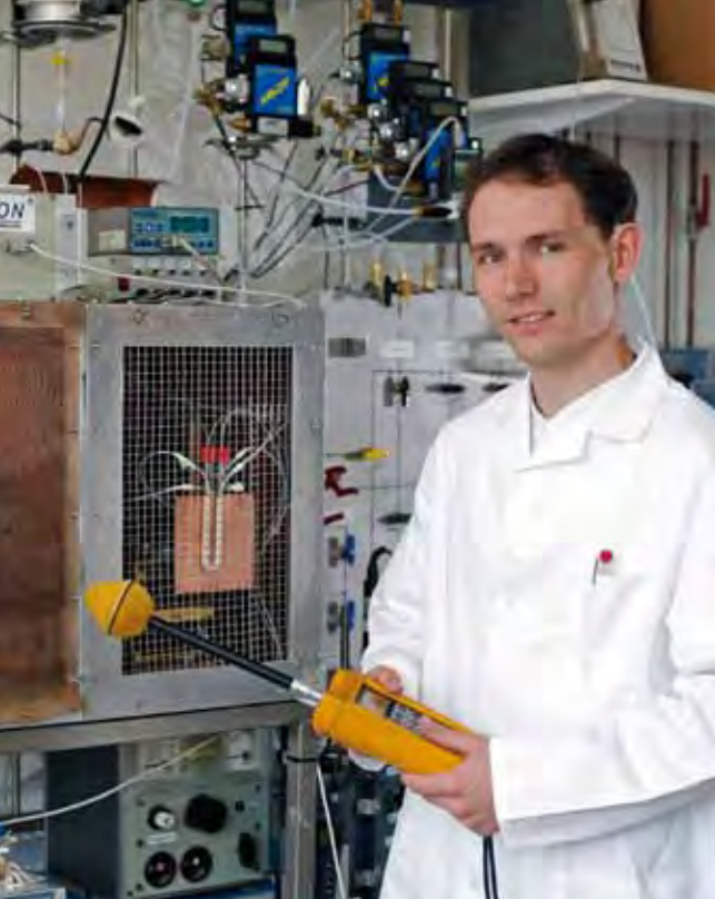
Physiker Markus Kraus untersucht am Messplatz für Hochfrequenz-Messungen Absorptionseigenschaften von Zeolith.
