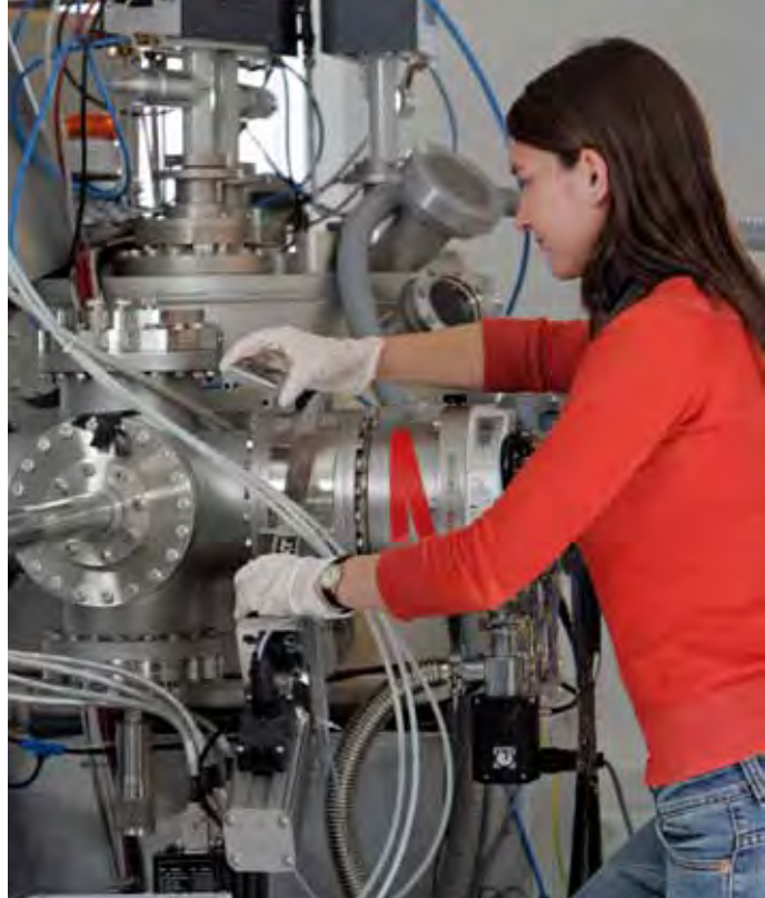
Physikerin Johanna Lutz vor einer Anlage zur Plasma-Immersions-Ionenimplantation, die die homogene Implantation in beliebige dreidimensionale Körper erlaubt.
