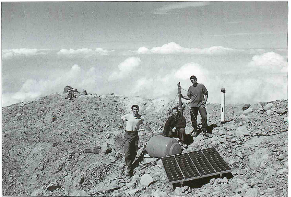
Die Geophysiker Sven Friedel, Carsten Rücker und Thorsten Wanger nach Installation der Monitoring Station für natürliche elektrische Signale an einer Solfatare des Vulkans Merapi.
