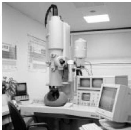
Das 200 keV-Durchstrahlungsmikroskop mit EDX-Detektor, TV-System, Analyse- und Bildverarbeitungssystem. Foto: E. Stern
