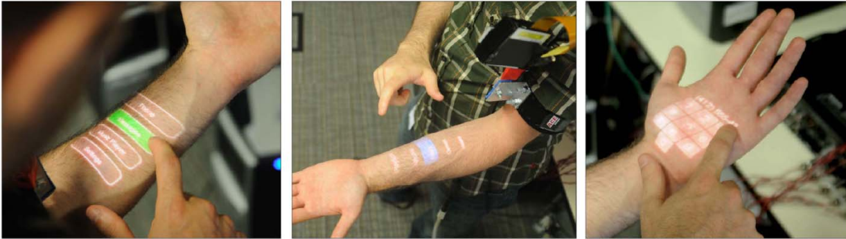
Abbildung 9. Das Sensorarmband ortet mit Mikrofonen die Position, an der die Haut berührt wird. Die Tasten werden über einen am Körper befestigten Projektor abgebildet [39]
