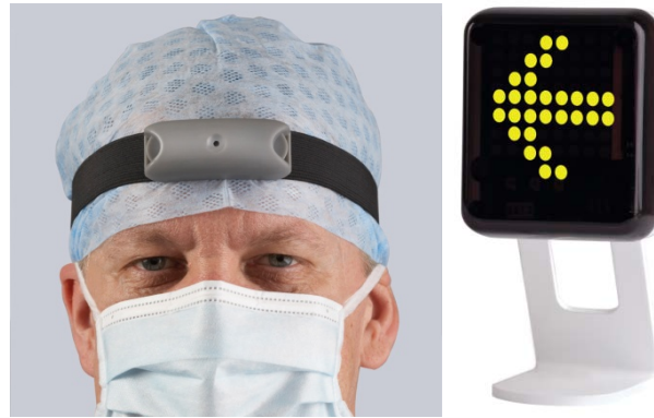
Abbildung 8. Bei dem Produkt „Freehand“ wird der Infrarotsender am Kopf des Operateurs befestigt (links). Der fest stehende Empfänger kann dadurch die Bewegungen detektieren und anzeigen (rechts)[Copyright Freehand 2010 Ltd]
