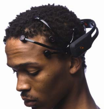
Abbildung 10. Das Epoc-Headset von Emotiv zur preisgünstigen Ableitung von EEGs [Copyright Emotiv, USA]
