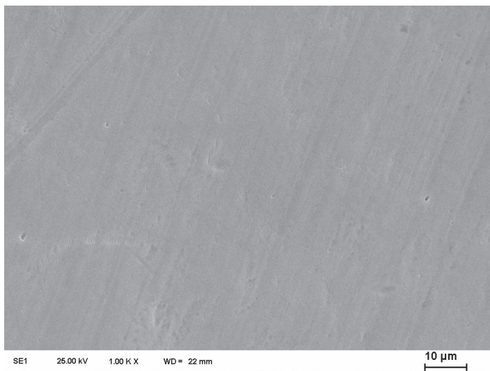
Abbildung 11: Rasterelektronenmikroskopisches Bild der Oberflächenstruktur der Titan-Oberfläche
