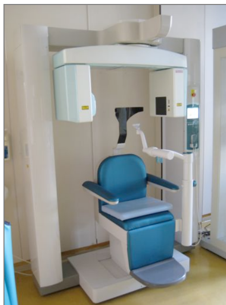
Abb. 25: In der Studie verwendetes DVT-Gerät 3D-Accuitomo 80 der Firma J. Morita. Quelle: eigene Aufnahme (22.06.2010)
