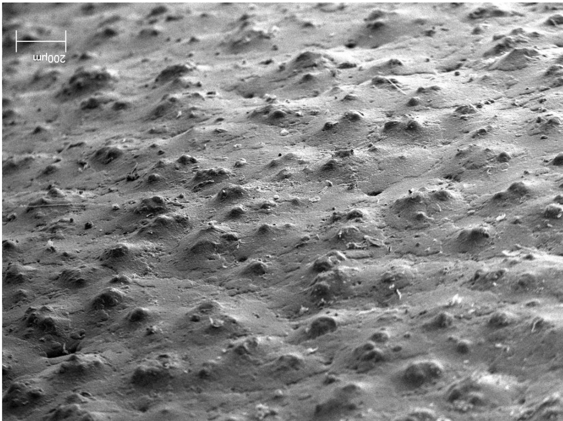
Abbildung 47: Poldefektes Ei, Aufsicht auf die Eischale im Eischalenspitzenbereich, hügelige Landschaft, Bild 180° gedreht
