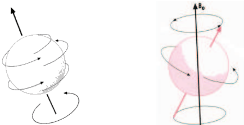
Abb. 2.5: Das magnetische Moment (links) und Präzessionsbewegung des magnetischen Moments (rechts), B_0 = Feldrichtung des statischen Magnetfeldes (modifiziert nach SCHNACKENBURG 2005).
