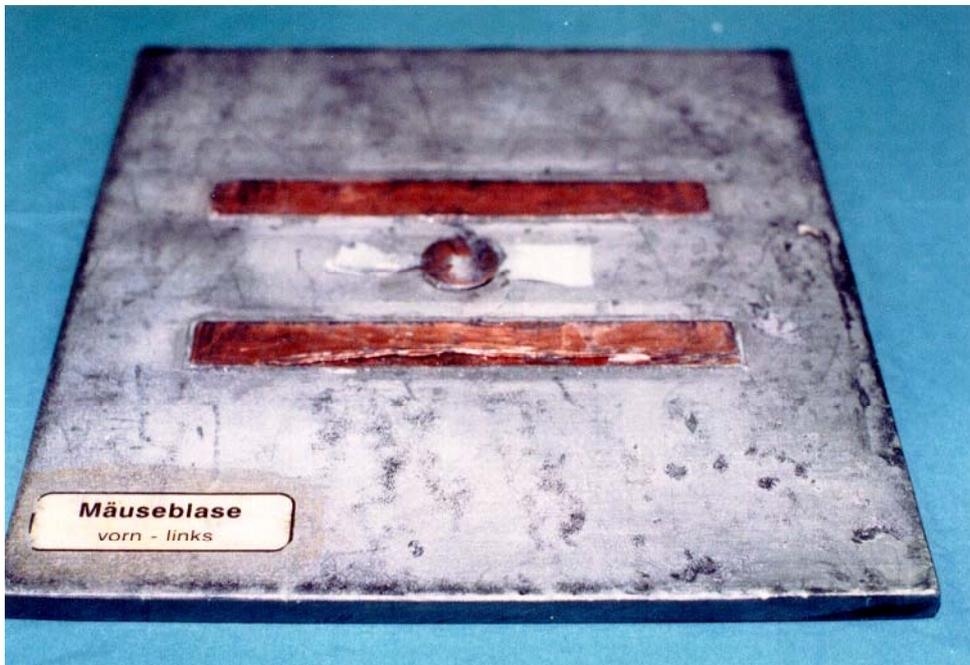
*Abbildung 5:* Kollimatorplatte zur Bestrahlung der Mäuseblasen
