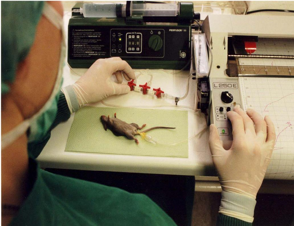
*Abbildung 7:* Aufbau eines zystometrischen Messplatzes mit Pumpe, Druckwandler und Schreiber, verbunden über druckresistente Schläuche und Dreiwegehähne
